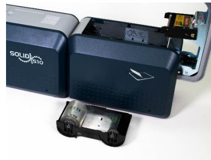
그림 22 라미네이터 필름 장착 2
