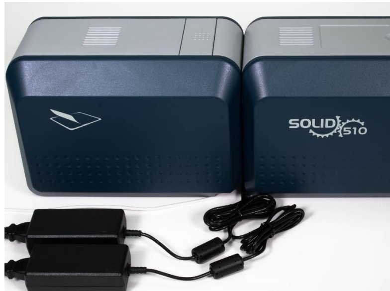
그림 12 SOLID-510L 전원 및 통신포트 연결 - 2
