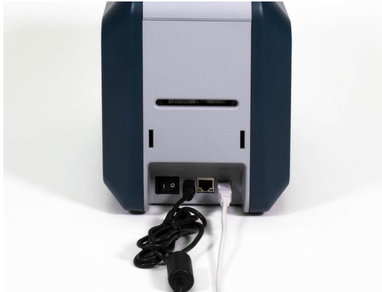
그림 9 SOLID-510S 전원 및 통신포트 연결
