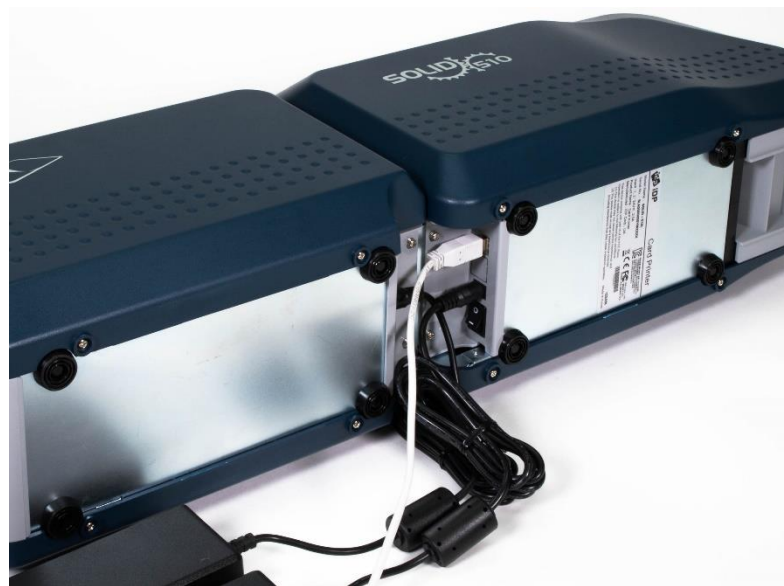
그림 11 SOLID-510L 전원 및 통신포트 연결 - 1
